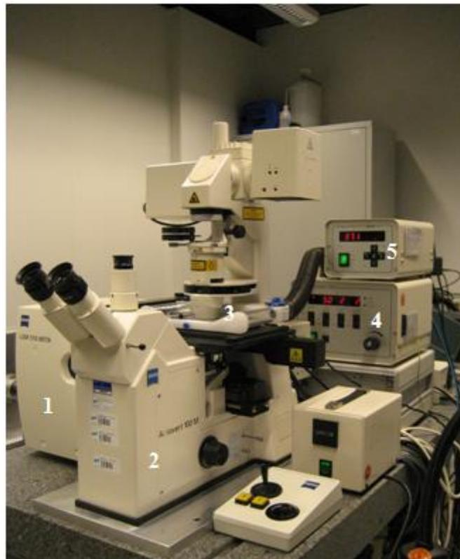
**Abbildung 7. Aufbau des Messsystems für die Zellmotilitätsstudien mittels *time-lapse*-Videomikroskopie**
