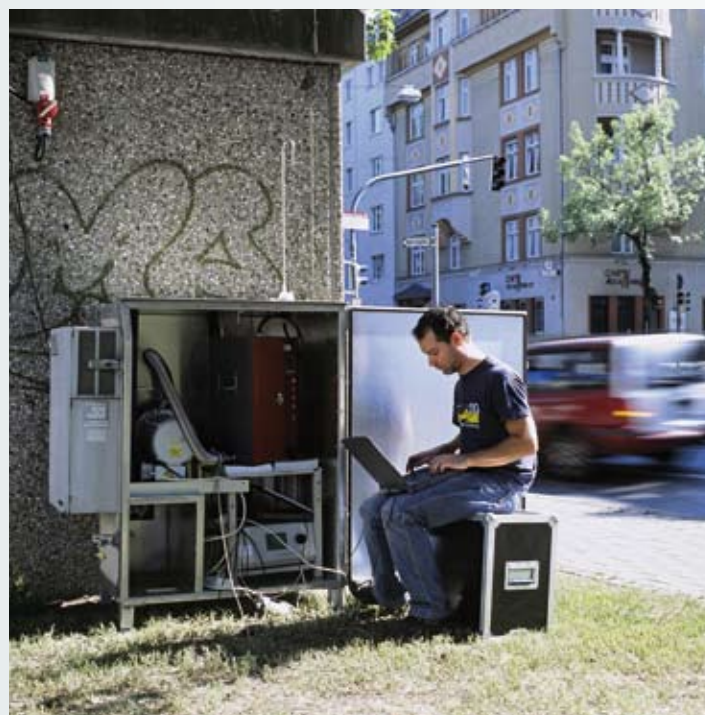
Feinstaub-Messstation an einer belebten innerstädtischen Straße.
