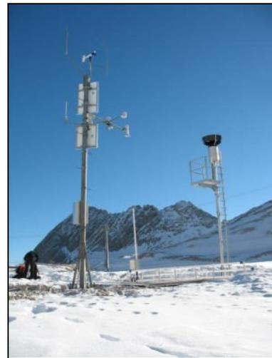
Abb. 2: Schnee-Messfeld am zentralen Zugspitzplatt (2420 m ü. NN) mit Instrumentierung zur Bestimmung meteorologischer und Schneeparameter (Ultraschall-Schneehöhensensor, Schneewaage, Snow Pack Analyzer). Die Station wird seit 2012 gemeinsam mit dem Bayerischen Lawinenwarndienst genutzt (Foto H. Schmölz, 21.11.2012).
