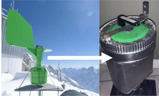
Abb.1: Umbau einer klassischen Pollenfalle an der UFS Bedingungen. Die Ansaugpumpe wurde durch eine Rotameter-kontrollierte Hochleistungspumpe ersetzt. Bild: S. Jochner.
