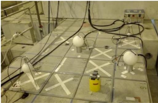
Abb.1: Vier Kugeln des HMGU Bonner Vielkugel-Spektrometers auf dem Betondach des CERF-Messplatzes am CERN. Bild: T. Brall
