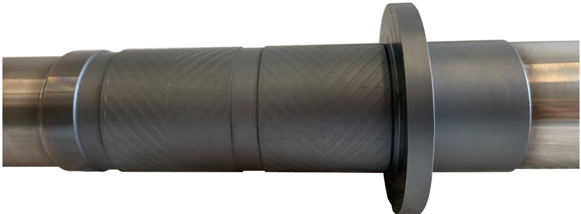
Abbildung 4.25: Finale Lagergeometrie mit Radialrillengleitlager und axialem Spiralrillengleitlager
