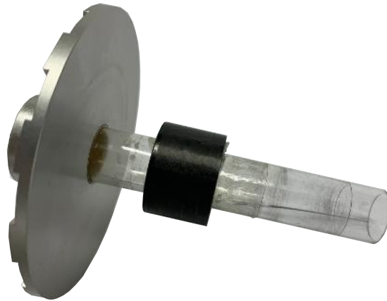
Abbildung 7.3: Bild des Rotors bestehend aus Glasrohr, Permanentmagnet und Scheibe mit Zähnen
