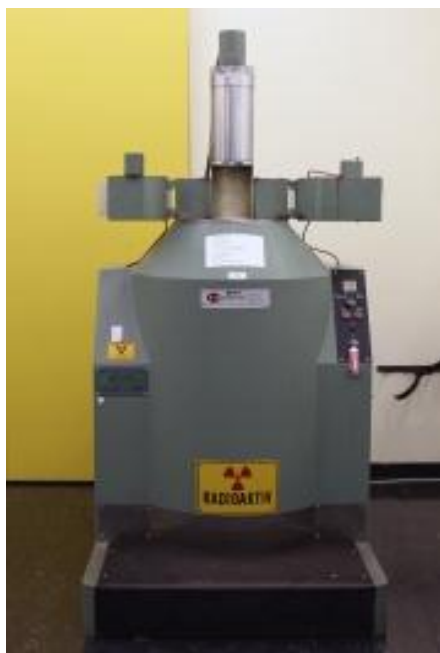
Figura 4.2 - Irradiador de Cobalto-60, Gamma Cell 220 I.
