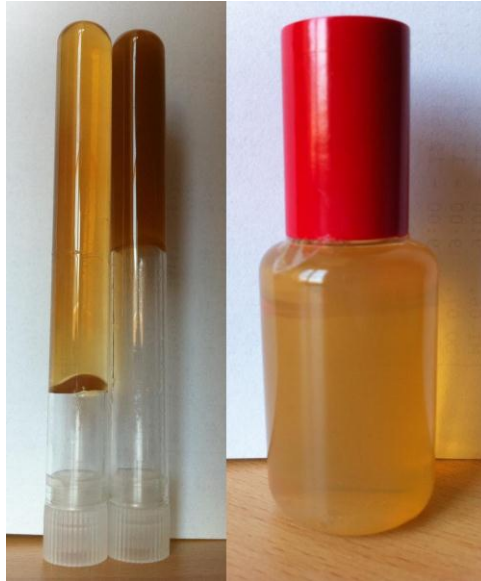
Figura 4.4 - Exemplos de porta-amostras utilizados neste trabalho. À esquerda: tubos de ensaio de vidro (com 10 cm de comprimento e 1,2 cm de diâmetro interno) e à direita: frasco de plástico Barex® (com 6 cm de comprimento e com 3 cm de diâmetro).
