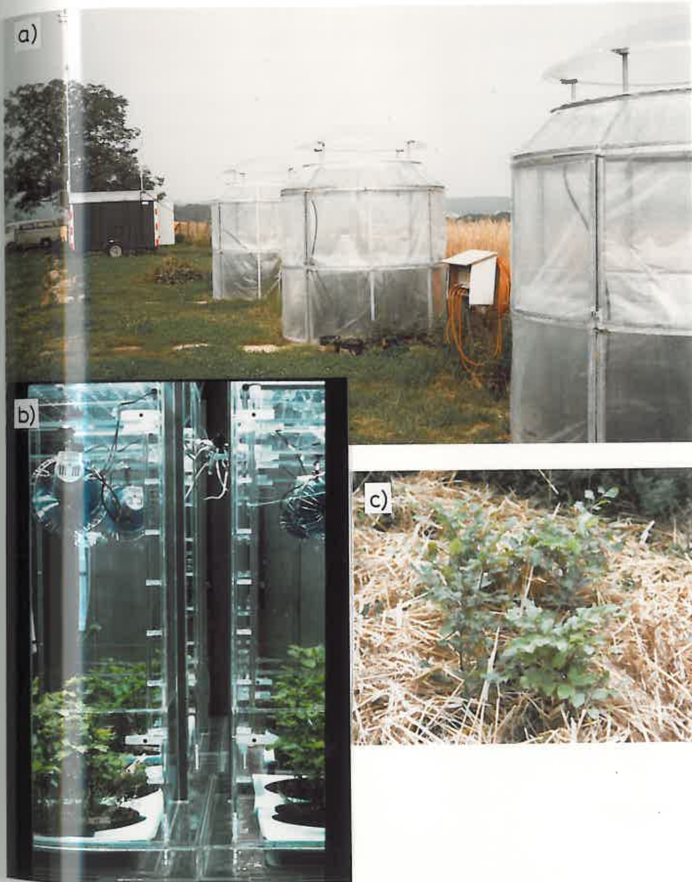
Abb. 9: a) Ansicht der Versuchsanlage in Schönenbuch, mit der Meßstation (links) und 2 Open-Top-Kammern (OTCs). Zwischen den OTCs wurden Buchen unter Freilandbedingungen exponiert (b). c) Einblick in eine Klimakammer (EPOKA) mit vier Küvetten, in denen Buchen unterschiedlichen Ozonbehandlungen ausgesetzt wurden.
